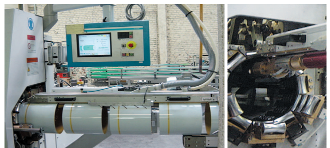
シーム溶接機( 無研磨・ワイヤー溶接 ) ~ 内面補修装置( パウダー・静電塗装 ) この後に外面補修装置( ラッカー・ハケ塗り )、加熱部と続く
