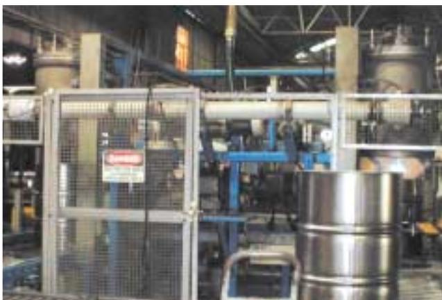
マススペクトロメーター(窒素を検出ガスとし、タイトヘッド缶とOP缶が同じ精度で検査できる)
